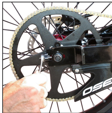
Chain tensioner nut (13mm)
